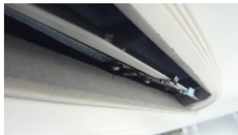
図 1.16 空調吹出口温度の測定状況
