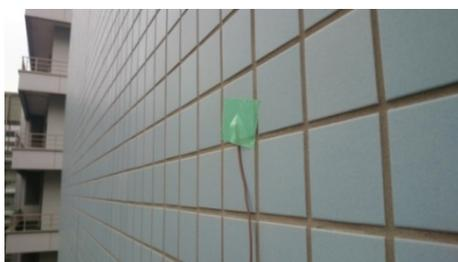
図 1.4 東外壁面外側温度の測定状況
