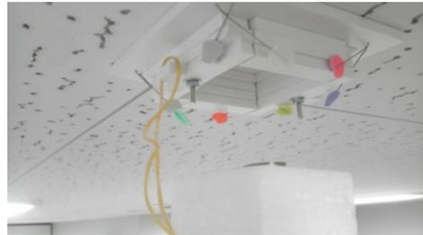
図 1.9 天井面温度の測定状況
