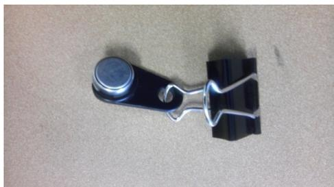
図 1.15 空調吹出口温度の測定機器
