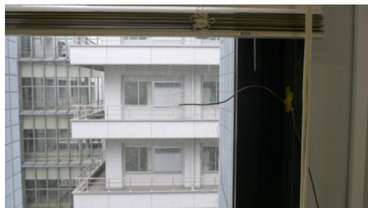
図 1.12 南窓面内側温度の測定状況
