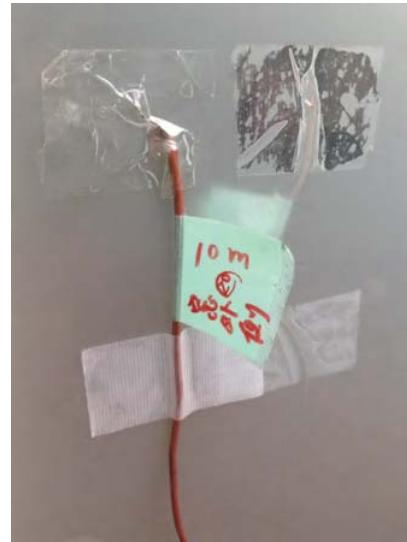
写真 2-11 E邸の窓外側表面温度の測定状況
