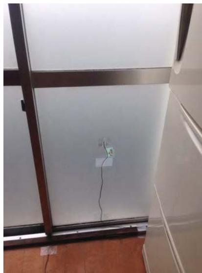
写真 2-10 E邸の窓内側表面温度の測定状況
