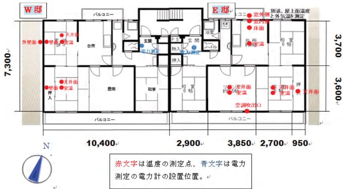
図 2-2 3 階平面図と測定点
