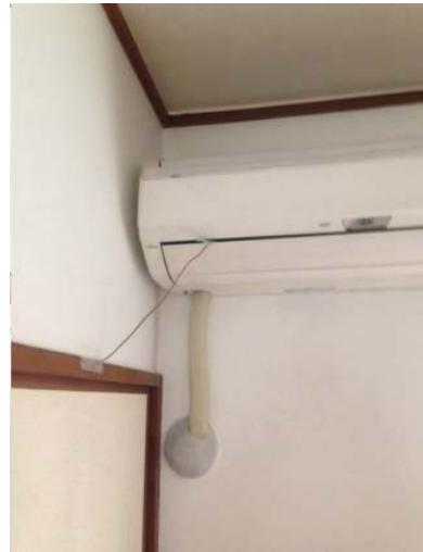
写真 2-6 热電対を接続したデータロガー 写真 2-7 E 邸の空調機吹き出し温度の測定状況
