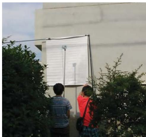
写真 2-5 外壁表面の日射反射率の測定状況
