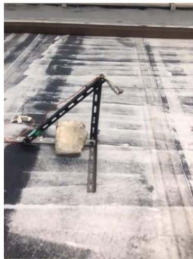
写真 2-4 赤外線熱電対による屋上表面温度の測定状況
