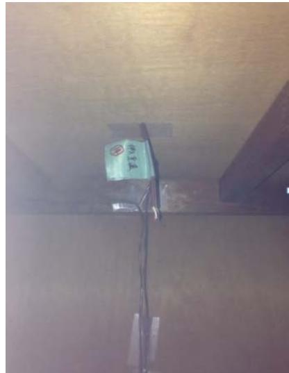
写真 2-8 W 邸の天井表面温度, 室温測定状況 写真 2-9 W 邸の押入内壁面表面温度, 室温測定状況
