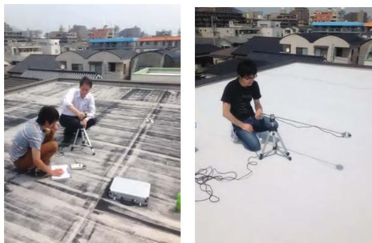
写真 2-2, 3 屋上表面の日射反射率の測定状況（左：改修前，右：改修後）
